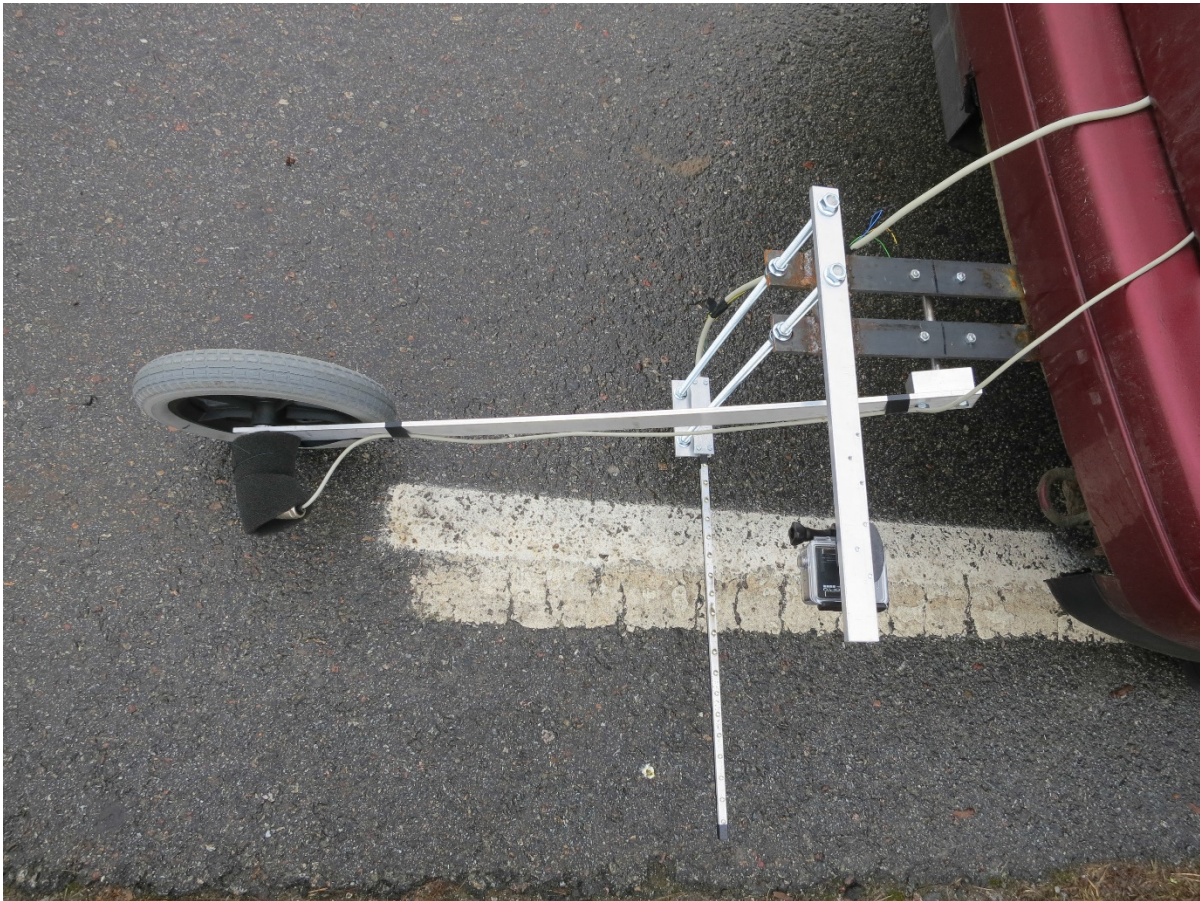
Bild 1, visar montering av lysdiodrad, odometerhjul och höghastighetskamera bak på testfordonet.
