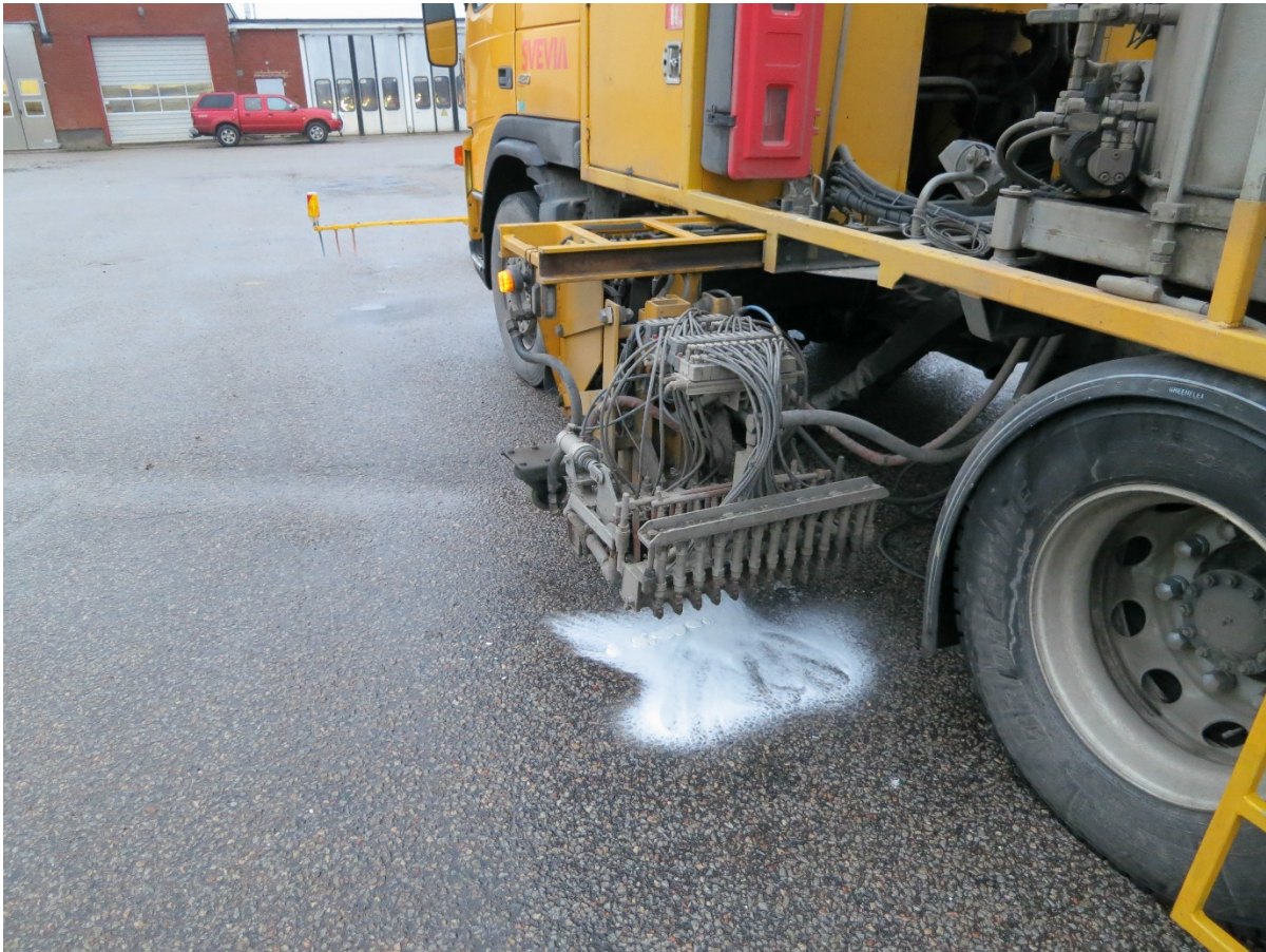
Bild 3, Redan i dag är extruden normalt monterad på en vagn så att den kan skjutas ut vid användning och skjutas in vid transport mellan arbetsobjekt. Bilden visar en typisk montering av en extruder.
